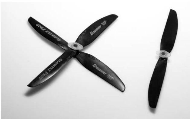
Εικ. 1.6: Δύο σταυρωτές προπέλες, 16 cm (τα γράμματα πάνω στην προπέλα πρέπει να κοιτάνε προς την γεννήτρια) και αναστραμμένη προπέλα (τα γραμμένα πάνω στην προπέλα να κοιτάνε προς τον φυσητήρα).
